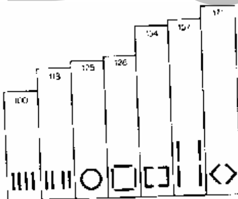
شکل (ث - ۱) - مقایسه درصد باردهی شینه‌هایی که دارای سطح مقطع مجموع یکسان هستند
